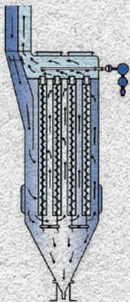
Фильтр рукавный СМЦ предназначен для обеспыливания различных промышленных газов, отходящих от технологических установок, работающих в различных отраслях промышленности: строительных материалов, цементной промышленности, металлургии, химической промышленности и т.д. Выпускаются три базовые модели фильтров с площадью фильтрации 35, 60, 90 кв.м, которые в зависимости от производительности могут устанавливаться последовательно до 5 в ряд.
